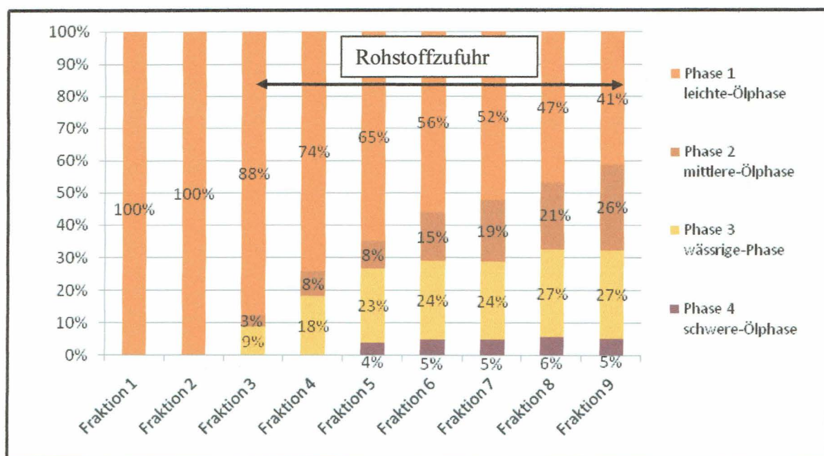
Abb. 28: Kondensatfraktionen, aufgefangen in einem thermischen 1 kg/h Strohversuch, Laboranlage, 370 °C, kein Katalysator (Masterarbeit A. Lüken, HAW Hamburg, April 2008)
