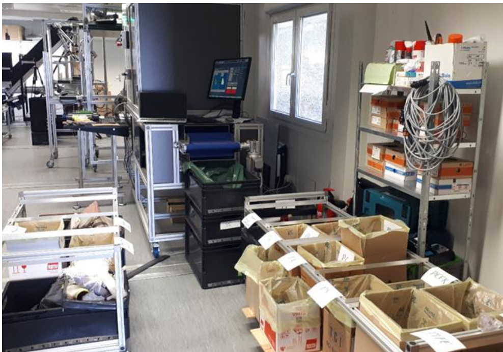
Abbildung 14: Aufbau der Ablagebehälter für die Sortierversuche. In der Bildmitte das Bandende zur Abnahme der detektierten Teile. Die Teileaufgabe erfolgt an der gegenüberliegenden Seite.
