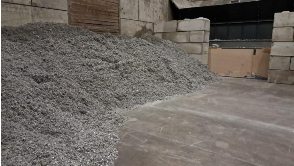
Abbildung 17 KORN EBS++-Material nach dem Lohnschreddern (vgl. Dichten)
