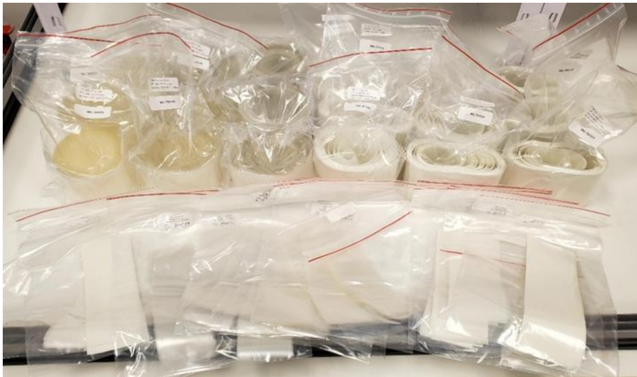
Abbildung 27: Testfolien zur Einrichtung des NIR-Sorters und die Bestimmung der Marker-konzentration für die Versuchskampagne
