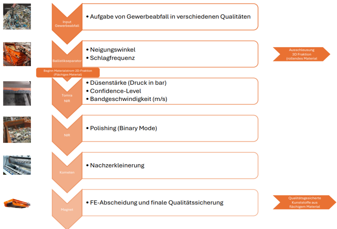
Abbildung 11 Prozesskette der 2D-Fraktion (Serienbetrieb)
