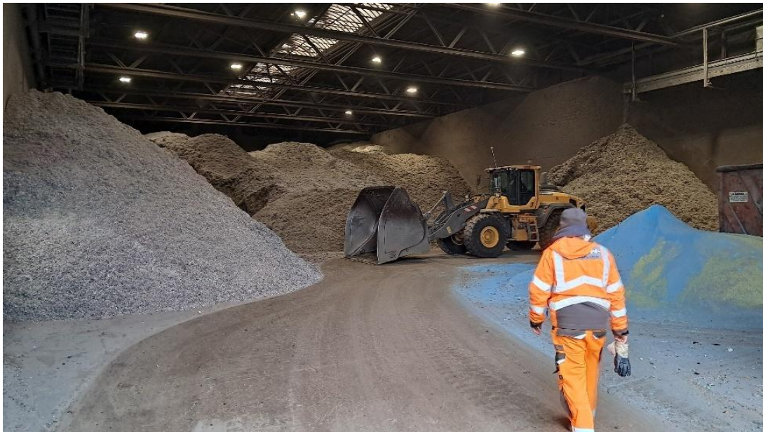
Abbildung 14 EBS-Lager bei KORN mit Radlader zur Beladung des LKW (HN-FK-450)
