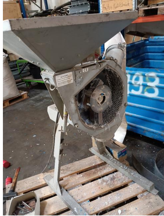
Abbildung 24: Schneidmühle zur Zerkleinerung der Proben in Ennigerloh
