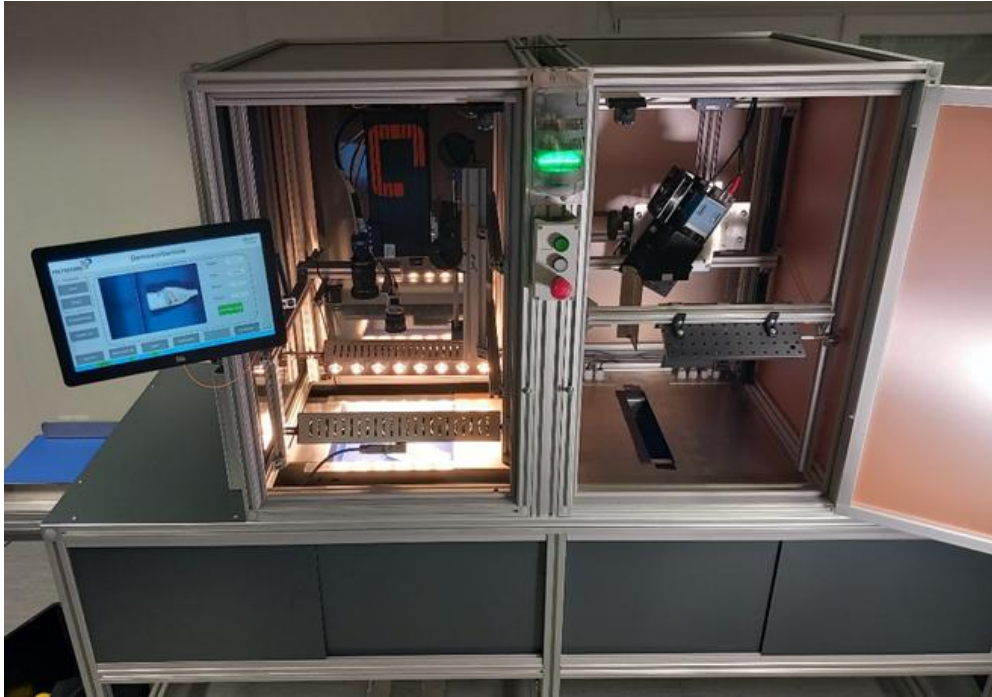
Abbildung 13: Detektionskammern der S4C-Versuchsanlage. Links: VIS- und NIR-Kammer, rechts: Markerdetektion (im Versuch nicht verwendet)
