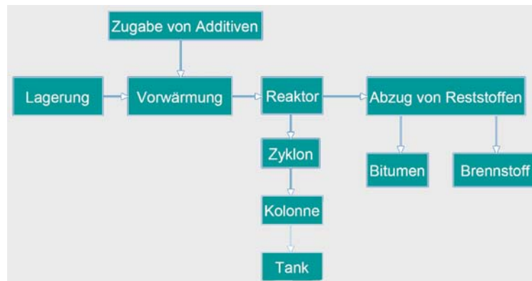
Abbildung 6-39: Blockschaltbild Clyvia [Stölzer06]
